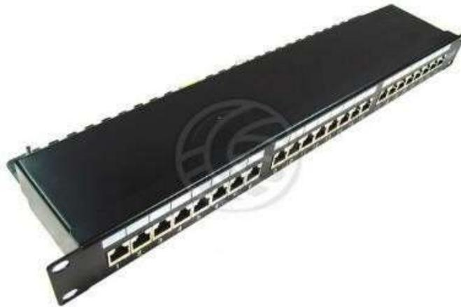
Patch panel de 1U y de formato 19" para ser instalado en un armario rack. Dispone de 24 conectores RJ45 STP/FTP 568B CAT6. El apantallamiento es a nivel particular para cada conector y además global para todos los conectores pues dispone de una carcasa metálica que cierra todos los conectores por su parte interior. En la parte trasera dispone de peine para ordenar los cables y toma de tierra para empalmarla al armario rack.
