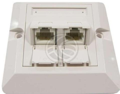
Esta placa es compatible con un cajetín de pared de (80x80) mm y de color marfil. Dispone de dos conectores del tipo RJ45 hembra con pin-out preparado para la normativa TIA-568B. Es compatible con UTP Cat.6. Incluye tornillería plaquita para identificación de los puertos.
