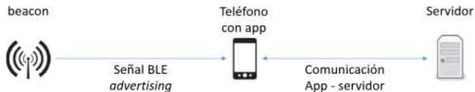
Ilustración 13. Esquema funcionamiento del sistema. Basado en (A. Corna, 2015)
