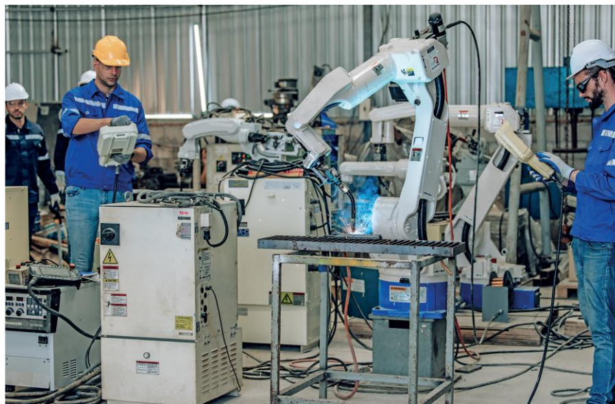
Figura 2.15. La robótica colaborativa se emplea para ejecutar tareas peligrosas o no ergonómicas, liberando al personal de estas funciones.
