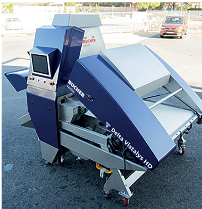
Figura 2.19. Esta mesa clasificadora elimina las impurezas que arrastra un racimo de uvas durante el proceso de la separación de la uva.
