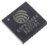
Para ocupar este hueco en el mercado la empresa china Espressif (<https://www.espressif.com/>), líder mundial en fabricación de Chips y módulos de comunicación Wi-Fi, desarrolló un 'Chip' que contenía un microcontrolador de 32bits (Tensilica L106), 50kb de memoria RAM, una entrada analógica de 10bits, 17 pines de entradas/salidas digitales y un módulo WiFi de 2.4Ghz. Había nacido el SoC (System on Chip) **ESP8266**.
