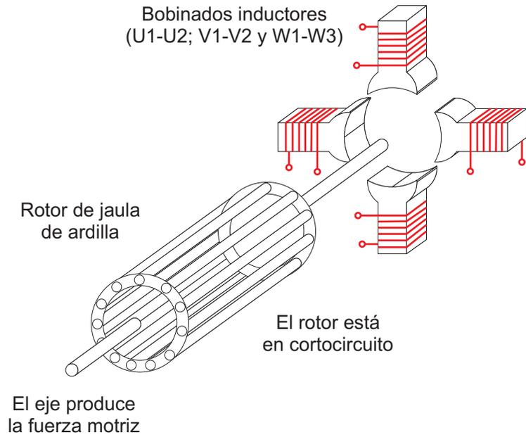
A los bobinados inductores se le aplica la tensión de funcionamiento
