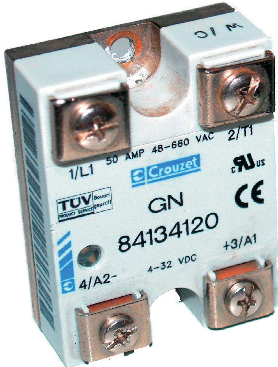
Para eliminar las sobreten-siones en relés de salida a corriente continua con carga inductiva, lo más eficaz es ubicar un diodo en paralelo con la carga.
