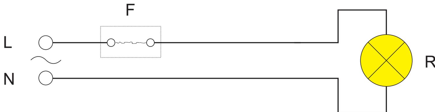
*Figura 5.1. Un fusible debilita de forma controlada una parte del circuito eléctrico.*
