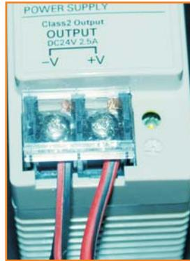
Figura 10.152. El led de la fuente de alimentación es un indicador de que la alimentación está correcta.
