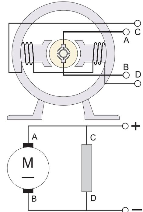
➔ Gráfico 25.4. Bobinados de una máquina de corriente continua excitación en derivación.
