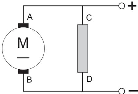
Bobinados de una máquina de corriente continua excitación en derivación.
