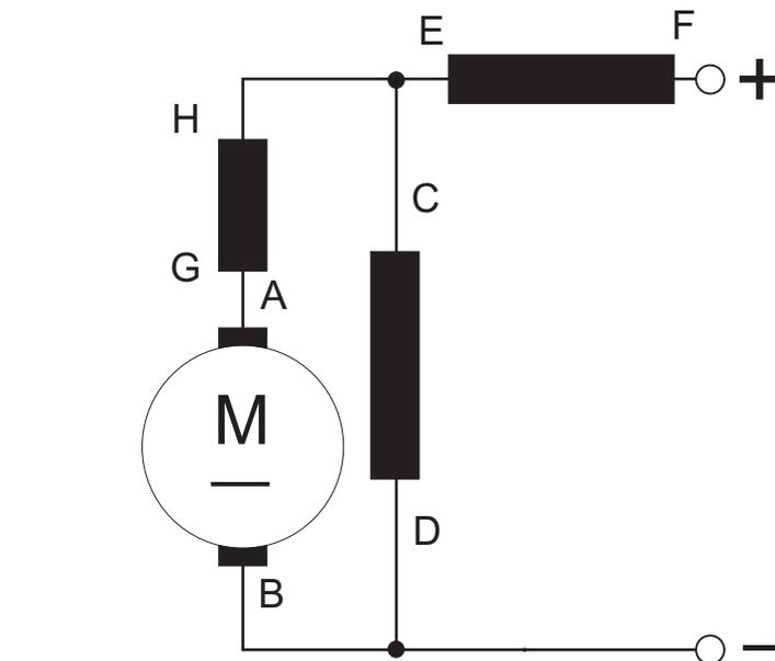
Motor con excitación compuesta (compoud), con bobinados auxiliares
