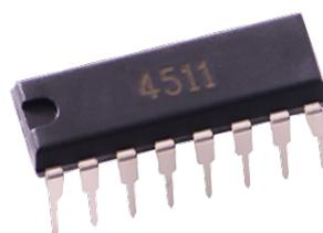
El código BCD (Decimal Codificado a Binario) es un estándar muy utilizado para representar los dígitos del 0 al 9 en código binario. Para ello necesitamos como mínimo 4 bits. El display de siete segmentos está compuesto por 7 diodos LED nombrados de la “a” a la “g” que según este encendidos o apagados representan los números en sistema decimal.
