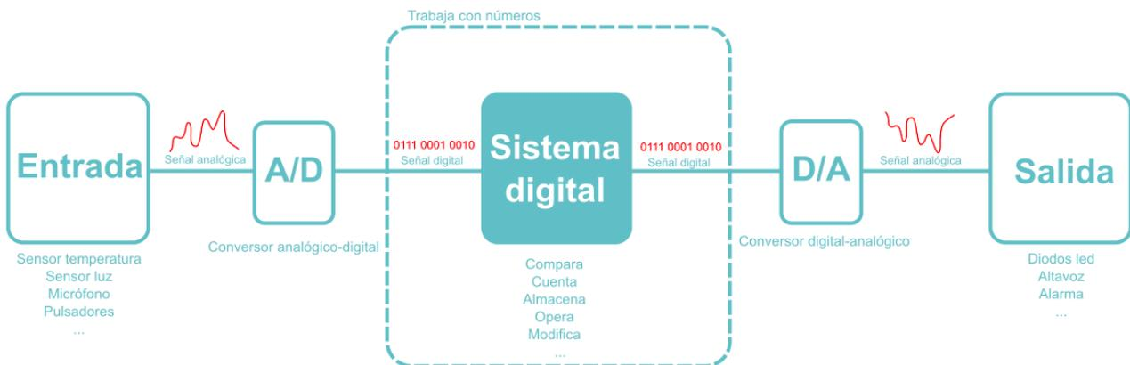
Como vemos en el esquema, la electrónica digital parte de una señal analógica que convierte en digital (código binario) para tratarla y finalmente la vuelve en convertir en analógica.
